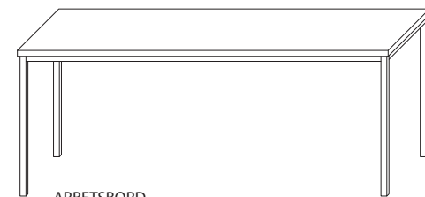
ARBETSBORD TOPPSKIVA MED HÖGTRYCKSLAMINAT BENSTATIV ROSTFRITT ELLER LACKERAT L1000-3000 B500-1240 H350-1100 (ALLA BORD ÖVER L2000 BEHÖVER STÖDBEN PÅ MITTEN)
